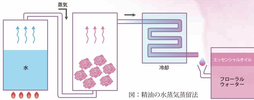
図：精油の水蒸気蒸留法
